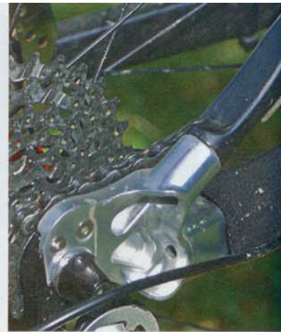
DIESE »FLEXZONE« ERSETZT DEN LAGERPUNKT AM AUSFALLENDEN
