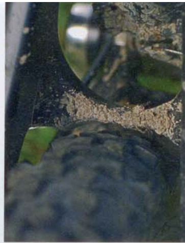
DIE HÖHE DES REIFENS ENTSCHEIDET, OB ER IN DEN HINTERBAU PASST
